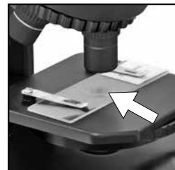
Para la observación normal, debes colocar el microscopio en un lugar donde haya claridad (junto una ventana o un flexo). Gira el tornillo micrométrico (2) hasta el tope superior y ajusta el revólver con objetivos (3) al aumento más pequeño.
