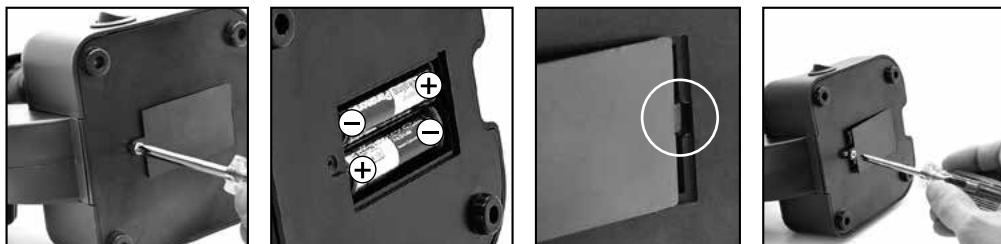
Pour l'observation de la source de lumière électrique (6), vous devez insérer deux piles AA 1.5V, dans le compartiment de la batterie (8) sur la base du microscope (7). Le compartiment des piles est ouvert à l'aide d'un tournevis cruciforme. Insérez les piles avec la polarité (+/- d'indication). Mettez le couvercle de la batterie en premier dans la petite ouverture pour que le couvercle s'adapte parfaitement. Maintenant, vous pouvez serrer la vis.
