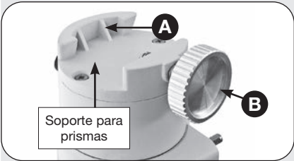
Fig. 8: Desatornillar el tornillo de bloqueo en el soporte del prisma.
