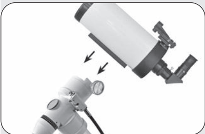
Fig. 8a: Insertar el tubo óptico con la riel del prisma en el soporte del prisma y fijarlo en su lugar.
