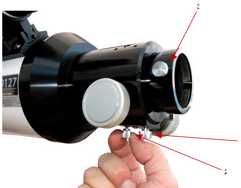
Fig. 8, 10:1 Mise au point à 2 vitesses
