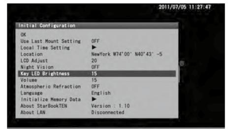
2 Im Dialogfeld "Key LED Brightness" (LED Tastenhelligkeit) geben Sie mit der Taste (▲) oder (▼) den gewünschten Wert zwischen 0 und 20 ein und drücken Sie die Taste (ENTER), um den Cursor auf OK zu setzen.
