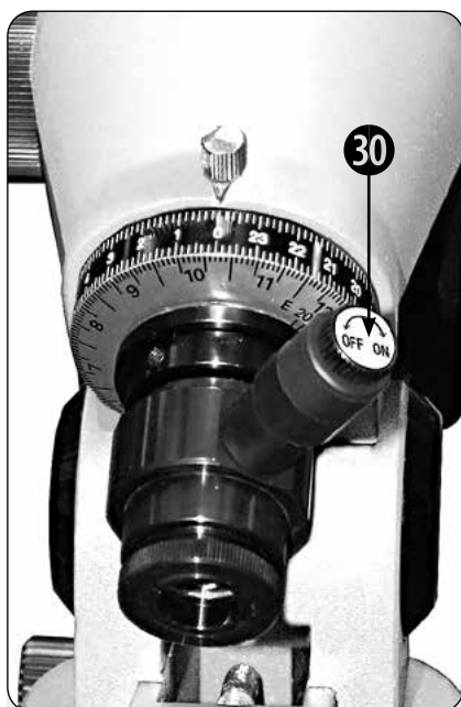
Fig. 37: Vista in dettaglio: cercatore polare con manopola (ON/OFF)
