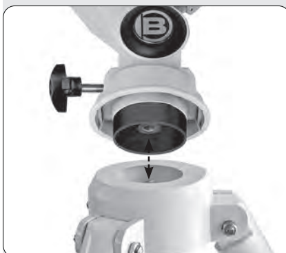
Fig. 5 Montage de la monture sur le trépied
